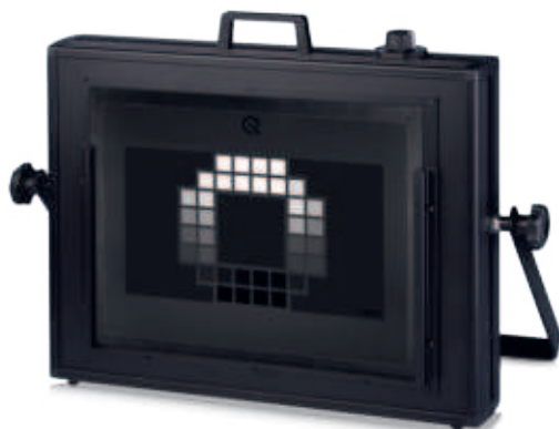
OECFテストチャートTE269を使用中のLG4 (テストチャートTE269は別売)
