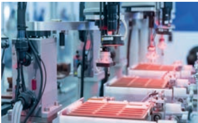
生産ラインで同時に複数のカメラモジュールを校正
