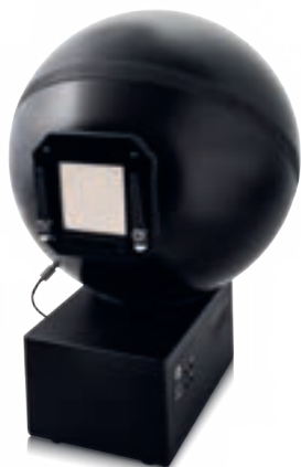
透過テストチャートD35サイズ用に改造されたCAL1
