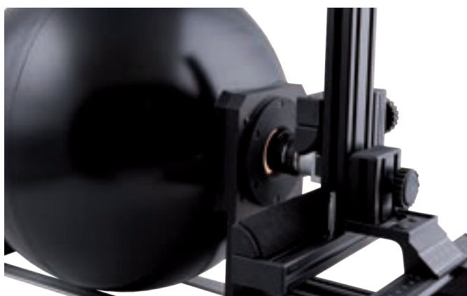
広角カメラシステムの校正と特性評価
