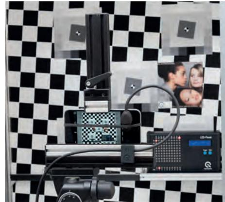
出机械手指IQ-Trigger加入时间测试套装中，使测试结果变得更加精确。只需要把机械手指IQ-Trigger架设在相机支架上，就可以同时调整并操作曝光按钮和开关。
