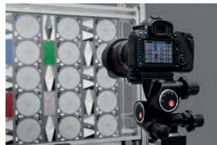
镜头吗？相机单脚架IQ-Monopod，再加上三向云台3-Way camera head，就能帮您避免相机与图卡失衡的麻烦。每年，IQ实验室都要用这套设备为成千上百个镜头进行测试。
