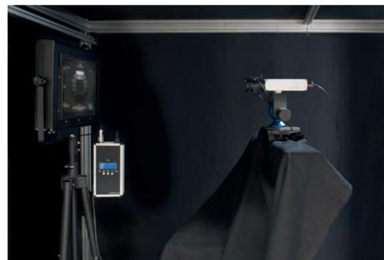
件下，可以用LED-Panel测量最大帧率。这套装备还包含了用于光照和曝光测量的所有模组、测量设备、图卡、摄像头以及IQ-Analyzer分析软件。
