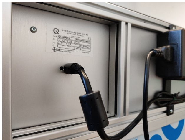
Abbildung 6-3 Verbindung des lightSTUDIO AW Heads mit dem Netzteil
